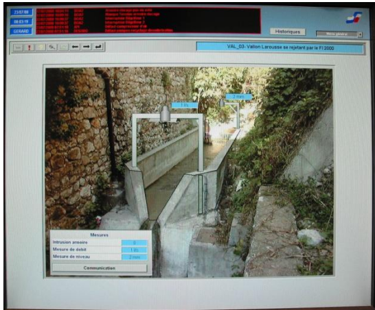
Visualisation du vallon La Rousse sur PcVue, avec les mesures de niveau et de débit.
