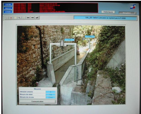
Visualizzazione della valle La Rousse su PcVue, con le misure di livello e di portata.
